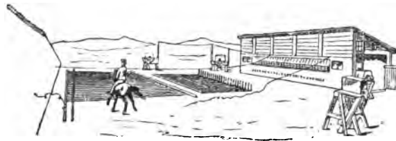
Fig. 114. Rennbahn mit Vorrichtung zum Photographiren des Pferdes.
