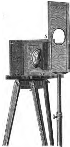
Fig. 15. Befestigung des Momentverschlusses auf einem eigenen Stativ.
