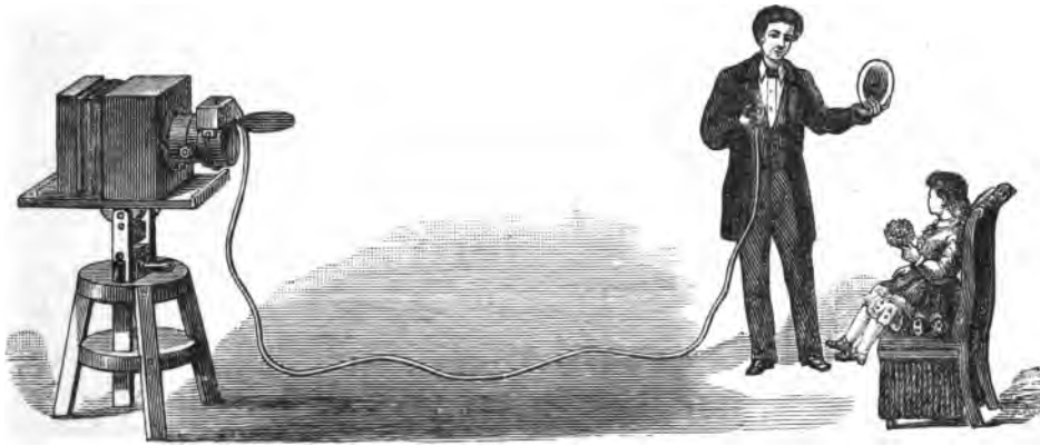
Fig. 6. Aufnahme eines Kindes mittels eines pneumatischen Objectivverschlusses.
